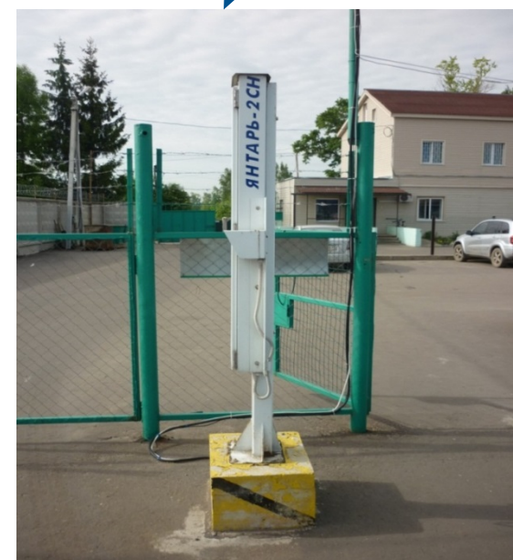
Система радиационного контроля ЯНТАРЬ-2СН
